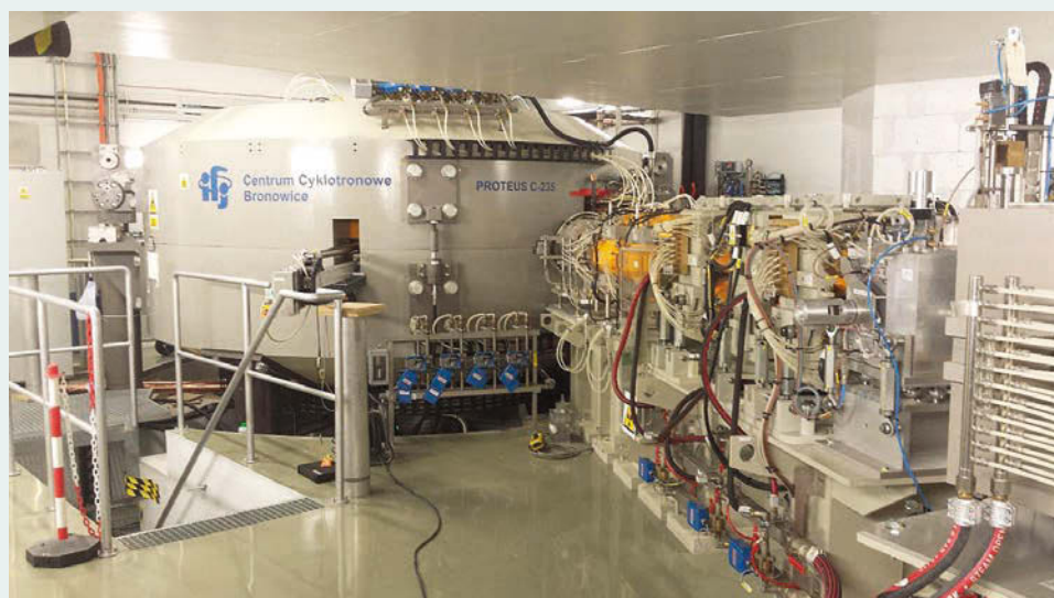
Fot. 1. Cyklotron Proteus-235 w Centrum Cyklotronowym Bronowice, przyspieszający protony do energii 230 MeV.
