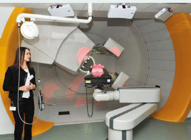
Fot. 2. Pokój terapeutyczny gantry w Centrum Cyklotronowym Bronowice. Widać wysunięte dwa panele rentgenowskie wokół fantomu spoczywającego na stole robotycznym. Do sufitu zamontowano trzy kamery systemu Align RT dla optycznego pozycjonowania pacjenta.
